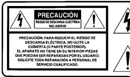
Este símbolo tiene por finalidad alertar al usuario acerca de la presencia de tensión sin aislación en el interior del producto, que puede tener la intensidad suficiente como para causar descargas eléctricas. Por lo tanto, hacer contacto con cualquier pieza en el interior de la unidad es peligroso.
